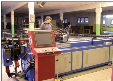
Spetsiaalselt ostenud torukoolutuspink võimaldab anda soovitud kuju kuni 6 meetri pikkusele metalltorule
